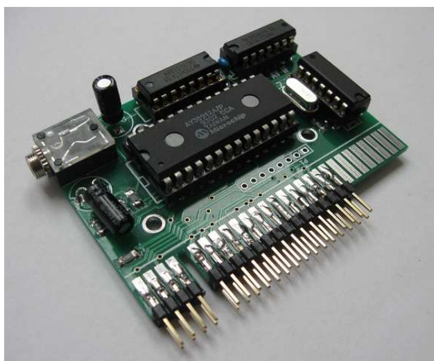
interface v provedení pro rozšiřující sběrniciovou desku ZX ExpBoard
